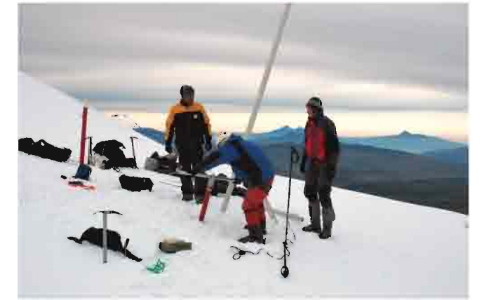
* Extracción de testigos de nieve para medir su densidad y estimar la capa de agua acumulada por las precipitaciones en un año. Zona de acumulación del glaciar 15 del Antisana a 5400m. (©B.Francou, 2008)
