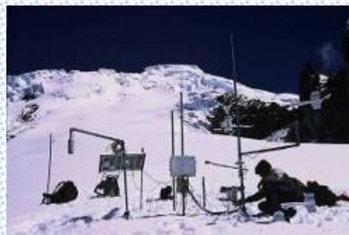
Stations installées in situ, à 5000 m et plus, pour mesurer les bilans d'énergie. Ces stations forment l'unique réseau de haute altitude existant dans les Andes et sous les tropiques. Photos BF IRD
